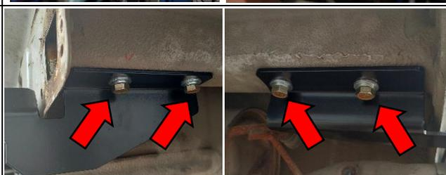
**ШАГ 3.** Проложите жгут проводов от комплекта электрики и установите в обратной последовательности снятые детали с автомобиля (аккуратно подрезав задний бампер только для Vesta Cross/ Vesta SW Cross) снизу посередине прямоугольным отверстием 60x50 мм. Установить **кронштейн розетки (поз. 11)** и закрепить ее **гайкой M8 (поз. 3)** через **шайбу 8 пружинную (поз. 4)**. Подключить электрику: розетку, жгут проводов, блок согласования (если требуется)
