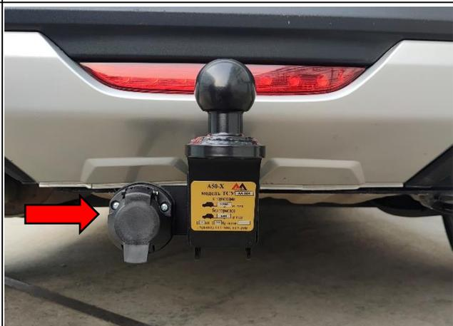
**ШАГ 4.** Установите **съемный шар (поз. 7)** закрепив его **пальцем (поз. 6)** и **шплинтом (поз. 2)**. Закрепите **съемный шар болтами M12 (поз. 8)** через **шайбы 12** и **пружинные шайбы 12 (поз. 10, 9)**.
